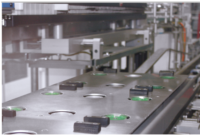
Плоские присоски SPF для использования в устройствах формирования картонных коробок
